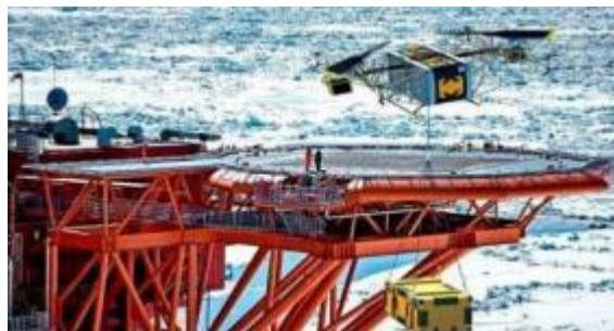
Рис 13. Грузовой дрон Skyf доставляет груз на платформу в Арктике 65
