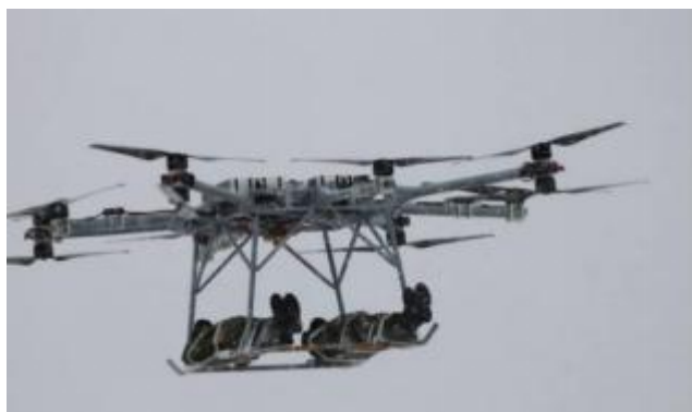
Рис 70. Испытания супертяжелого (460 кг.) эвакуокоптера АО «БВС», 2020 г., «Дронпорт»
