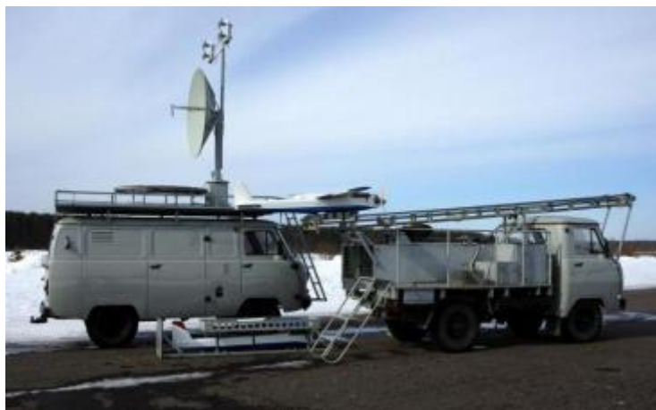
Рис 67. Станция управления (кунг) и транспортно-пусковая установка БВС «ГрАНТ» 285
