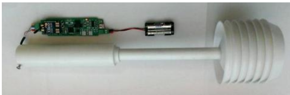
Рис 66. Портативная автоматическая метеостанция на платформе БВС 278
